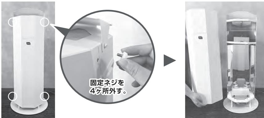
1) 本体カバー固定ネジ(4ヶ所)を外し、本体カバーを外してください。
