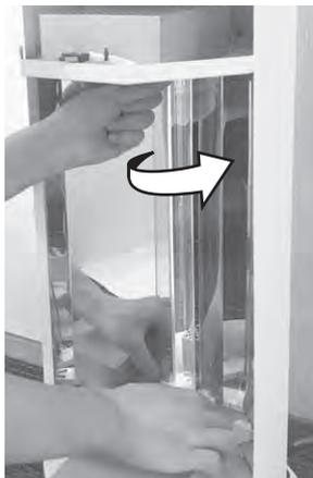
3) <3.ご使用方法2>を参照に、ランプをソケットから抜き、交換ランプ (GL15) を真ん中から取り付けてください。
